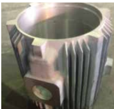
モーターフレーム(FC250、φ400mm×L370mm)
