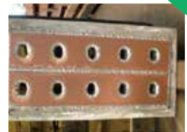
短絡ブスバー C1100 アルミ+銅 溶接
