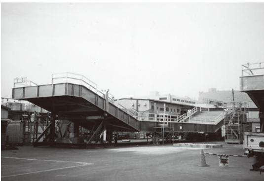
来島大橋下面点検作業車(アルミ) 本体 W.6300× L.35500× H.3400
