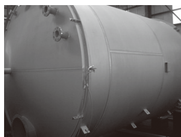
蒸留廃液槽 Ø2500×H4000
