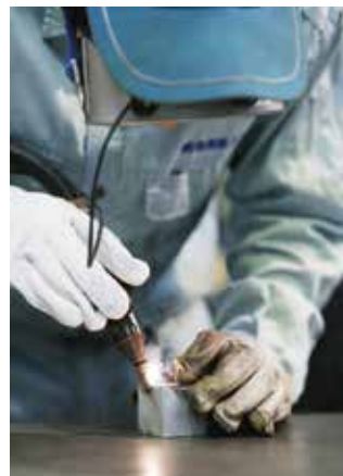
YAGレーザー溶接機 ハンドタイプで汎用性が 高い溶接機です。
