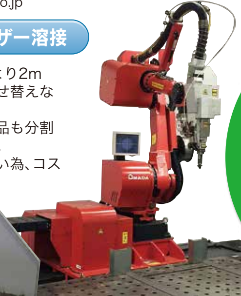
ファイバーレーザー溶接機 アルミ・チタンなどの特殊材溶接も 対応しております。
