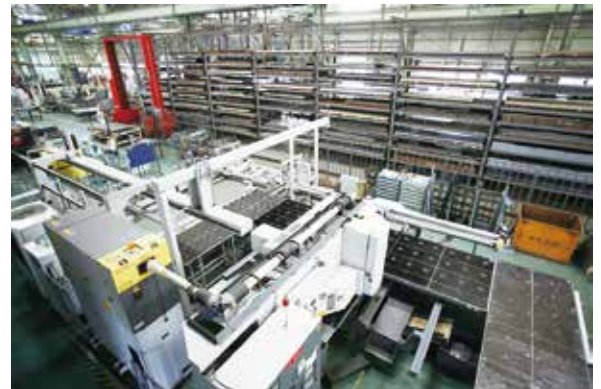
板金自動加工システム(全景) 材料製品棚との連動で無人運転が可能です。
