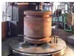
大型立旋盤 (製品の加工、圧延ロールの金型加工)
