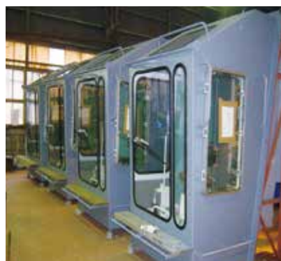
デッキクレーンキャビン ばら積み船や一般貨物船等に装備されるクレーン用運転室。
