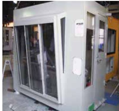
レールクレーン運転室 高熱作業等の用途に応じた特殊な構造のクレーン用運転室。
