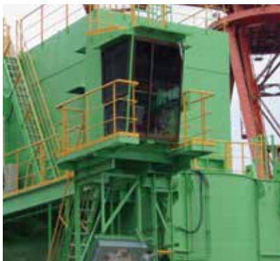
ジブクレーン運転室 ジブを有し、天井クレーンに次いで多く使用されるクレーン用運転室。
