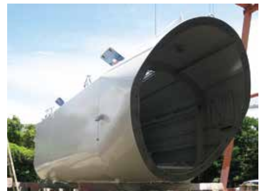
曲げ加工の技術 曲げ加工の技術は、風力発電機フレームや観覧車の Gondola など活かされています。
